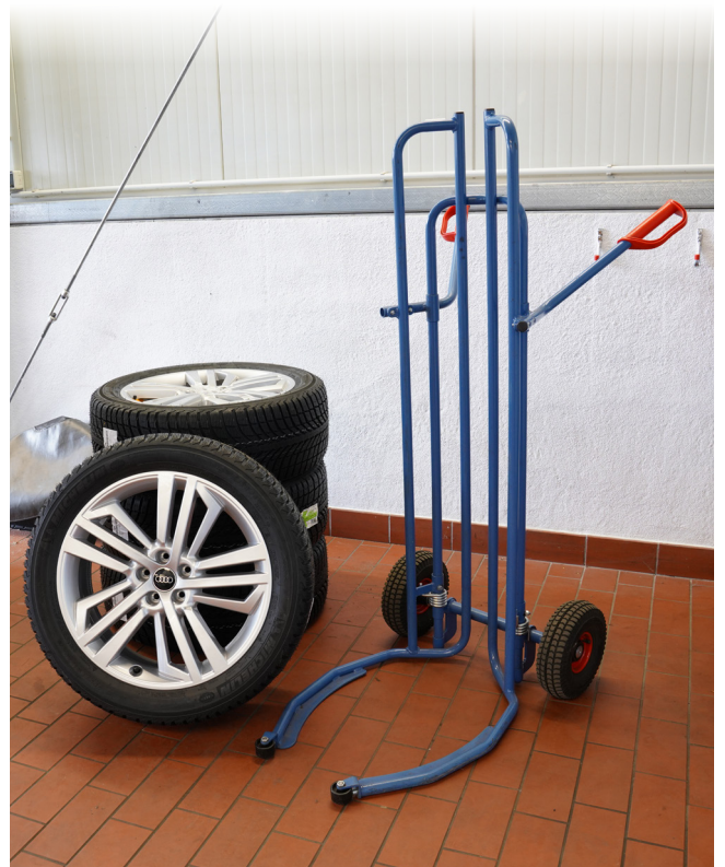
Unser Reifenkarre mit Spreizaufnahme und Anlaufrollen.
